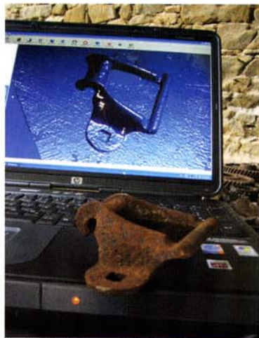
Maillon à oreille : objet réel et virtuel en nuage de points
